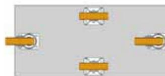
**Zwei Lenk- und Bockrollen, wobei die Bockrollen eine etwas höhere Bauhöhe aufweisen**
