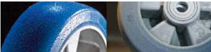
Überprüfung der Hydrolysebeständigkeit
