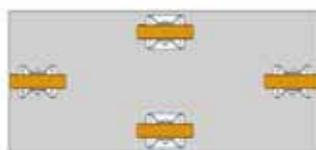
**Vier Bockrollen, wobei die mittleren eine etwas höhere Bauhöhe aufweisen**
