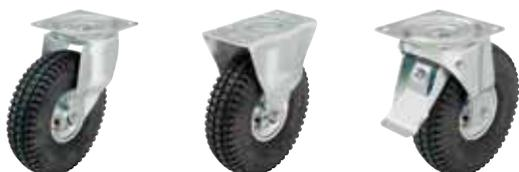
**Gehäuse:** Serie L/B - Aus Stahlblech gepresst , Lenkgehäuse mit zweifacher Kugellagerung im Drehkranz , mit stabilem Mittelbolzen , mit Drehkranzabdichtung (Ausnahme Plattengröße 175x175 mm) . Die spezielle dynamische Vernietung des Drehkranzes bewirkt ein minimales Drehkranzspiel bei leichtgängigem Lauf und eine hohe Lebensdauer durch die Kaltverfestigung der Kugellaufbahnen.
