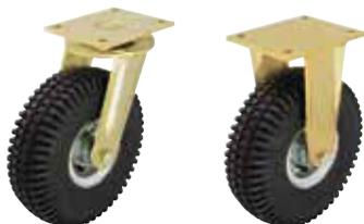
**Gehäuse:** Serie LS/BS - Besonders robuste Stahlschweißkonstruktion, Lenkgehäuse mit Axial-Rillenkugellager DIN 711 und Kegelrollenlager DIN 720 im Drehkranz, staub- und spritzwassergeschützt, mit Schmiernippel, mit eingeschweißtem, sehr stabilem Mittelbolzen verschraubt und gesichert.
