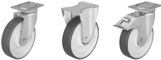
**Gehäuse:** Serie LU/BH - Aus starkem Stahlblech gepresst , Lenkgehäuse mit Vier-Punkt-Kugellagerung im Drehkranz für eine optimale Aufnahme von vertikalen und horizontalen Kräften , geschlossene , abgedichtete Drehkranz . Die Verwendung von gehärteten Lagerschalen in Verbindung mit der speziellen dynamischen Vernietung erhöht die Robustheit gegen Stöße und Schläge und bewirkt einen leichtgängigen Lauf bei geringem Verschleiß und hoher Lebensdauer .
