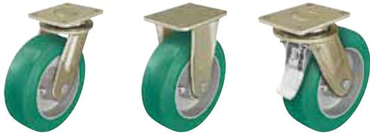
**Gehäuse:** Serie LS/BS - Besonders robuste Stahlschweißkonstruktion, Lenkgehäuse mit Axial-Rillenkugellager DIN 711 und Kegelrollenlager DIN 720 im Drehkranz, staub- und spritzwassergeschützt, mit Schmiernippel, mit eingeschweißtem, sehr stabilem Mittelbolzen verschraubt und gesichert.
