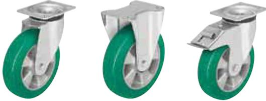
**Gehäuse:** Serie LK/BK/BH - Aus starkem Stahlblech gepresst , Lenkgehäuse mit zweifacher Kugellagerung im Drehkranz , mit stabilem Mittelbolzen (Rad-Ø 125x54 - 200 mm) , mit Drehkranzabdichtung . Die spezielle dynamische Vernietung des Drehkranzes bewirkt ein minimales Drehkranzspiel bei leichtgängigem Lauf und eine hohe Lebensdauer durch die Kaltverfestigung der Kugellaufbahnen.
