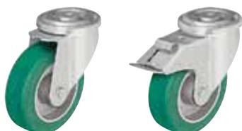
**Gehäuse:** Serie LKR - Aus starkem Stahlblech gepresst , mit zweifacher Kugellagerung im Drehkranz , mit stabilem Mittelbolzen , Kugelschutz durch besondere Formgebung der Bodenplatte und Kugelscheibe . Die spezielle dynamische Vernietung des Drehkranzes bewirkt ein minimales Drehkranzspiel bei leichtgängigem Lauf und eine hohe Lebensdauer durch die Kaltverfestigung der Kugellaufbahnen.
