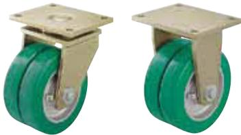
**Gehäuse:** Serie LSD/BSG - Besonders robuste Stahl - schweißkonstruktion, Lenkgehäuse mit Axial-Rillenkugellager DIN 711 und Kegelrollenlager DIN 720 im Drehkranz, staub- und spritzwassergeschützt, mit Schmiernippel, mit eingeschweißtem, sehr stabilem Mittelbolzen verschraubt und gesichert.
