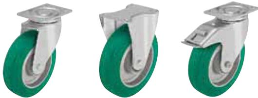
**Gehäuse:** Serie LH/BH - Aus starkem Stahlblech gepresst, Lenkgehäuse mit schwerer Gabel und Anschraubplatte, mit sehr stabilem Mittelbolzen verschraubt und gesichert, mit zweifacher Kugellagerung im Drehkranz, zusätzlich verstärkt durch vier speziell geformte, gehärtete Lagerschalen, dadurch besonders unempfindlich gegen Stöße und Schläge.
