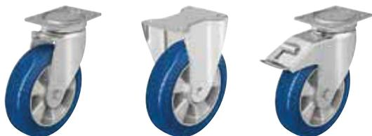
**Gehäuse:** Serie LU/BH - Aus starkem Stahlblech gepresst , Lenkgehäuse mit Vier-Punkt- Kugellagerung im Drehkranz für eine optimale Aufnahme von vertikalen und horizontalen Kräften , geschlossene , abgedichteter Drehkranz . Die Verwendung von gehärteten Lagerschalen in Verbindung mit der speziellen dynamischen Vernietung erhöht die Robustheit gegen Stöße und Schläge und bewirkt einen leichtgängigen Lauf bei geringem Verschleiß und hoher Lebensdauer .
