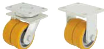
**Gehäuse:** Serie LOD/BOD - Solide Stahlschweißkonstruktion, Lenkgehäuse mit zweifacher Kugellagerung im Drehkranz, zusätzlich verstärkt durch **vier speziell geformte und gehärtete Lagerschalen**, Drehkranzabdichtung durch Labyrinthbauweise, mit Schmiernippel, mit eingeschweißtem, sehr stabilem Mittelbolzen verschraubt und gesichert.
