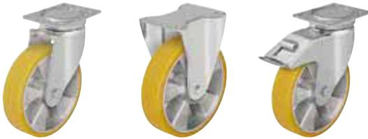
**Gehäuse:** Serie LU/BH - Aus starkem Stahlblech gepresst , Lenkgehäuse mit Vier-Punkt- Kugellagerung im Drehkranz für eine optimale Aufnahme von vertikalen und horizontalen Kräften , geschlossene , abgedichteter Drehkranz . Die Verwendung von gehärteten Lagerschalen in Verbindung mit der speziellen dynamischen Vernietung erhöht die Robustheit gegen Stöße und Schläge und bewirkt einen leichtgängigen Lauf bei geringem Verschleiß und hoher Lebensdauer .
