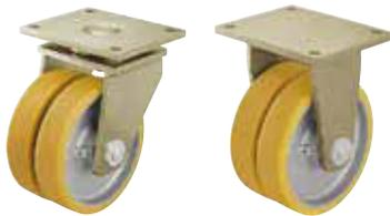
**Gehäuse:** Serie LSD/BSD - Besonders robuste Stahl - schweißkonstruktion , Lenkgehäuse mit Axial-Rillenkugellager DIN 711 und Kegelrollenlager DIN 720 im Drehkranz , staub- und spritzwassergeschützt , mit Schmiernippel , mit eingeschweißtem , sehr stabilem Mittelbolzen verschraubt und gesichert .
