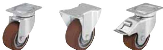
**Gehäuse:** Serie LU/BH - Aus starkem Stahlblech gepresst , Lenkgehäuse mit Vier-Punkt- Kugellagerung im Drehkranz für eine optimale Aufnahme von vertikalen und horizontalen Kräften , geschlossene , abgedichteter Drehkranz . Die Verwendung von gehärteten Lagergehäusen in Verbindung mit der speziellen dynamischen Vernietung erhöht die Robustheit gegen Stöße und Schläge und bewirkt einen leichtgängigen Lauf bei geringem Verschleiß und hoher Lebensdauer .
