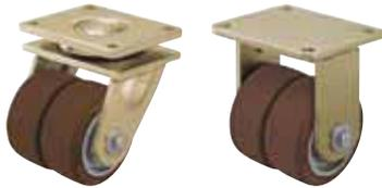
**Gehäuse:** Serie LSD/BS - Besonders robuste Stahl - schweißkonstruktion , Lenkgehäuse mit Axial-Rillenkugellager DIN 711 und Kegelrollenlager DIN 720 im Drehkranz , staub- und spritzwassergeschützt , mit Schmiernippel , mit eingeschweißtem , sehr stabilem Mittelbolzen verschraubt und gesichert .
