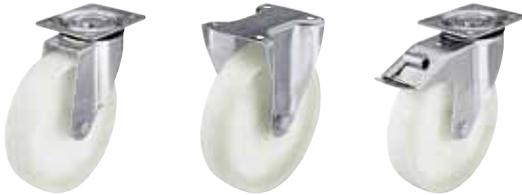
**Gehäuse:** Serie L/B/BH - Aus Stahlblech gepresst , Lenkgehäuse mit zweifacher Kugellagerung im Drehkranz , mit stabilem Mittelbolzen , mit Drehkranzabdichtung (Ausn. : Plattengröße 175x175 mm) . Die spezielle dynamische Vernietung des Drehkranzes bewirkt ein minimales Drehkranzspiel bei leichtgängigem Lauf und eine hohe Lebensdauer durch die Kaltverfestigung der Kugellaufbahnen.
