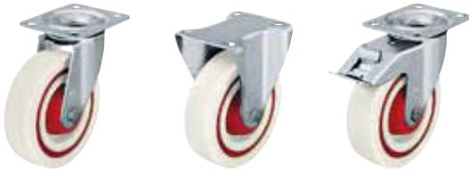
**Gehäuse:** Serie LE/B - Aus Stahlblech gepresst, Lenkgehäuse mit zweifacher Kugellagerung im Drehkranz, mit Drehkranzabdichtung. Die spezielle dynamische Vernietung des Drehkranzes bewirkt ein minimales Drehkranzspiel bei leichtgängigem Lauf und eine hohe Lebensdauer durch die Kaltverfestigung der Kugellaufbahnen.
