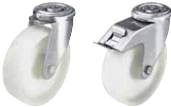
**Gehäuse:** Serie LER - Aus Stahlblech gepresst, mit zweifacher Kugellagerung im Drehkranz, mit stabilem Mittelbolzen, Kugelschutz durch besondere Formgebung der Bodenplatte und Kugelscheibe. Die spezielle dynamische Vernietung des Drehkranzes bewirkt ein minimales Drehkranzspiel bei leichtgängigem Lauf und eine hohe Lebensdauer durch die Kaltverfestigung der Kugellaufbahnen.
