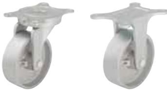
**Gehäuse:** Serie LT/BT - Aus hochwertigem ,weißem Temperguss , Lenkgehäuse mit zweifacher Kugellagerung im Drehkranz (Rad-Ø 65-80 mm : einfache Kugellagerung) , Kugelschutz durch besondere Formgebung der Anschraubplatte und Lenkgabel , mit Schmiernippel .
