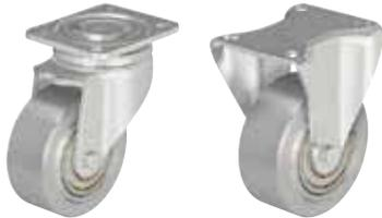
**Gehäuse:** Serie LH/BH - Aus starkem Stahlblech gepresst , Lenkgehäuse mit schwerer Gabel und Anschraubplatte , mit sehr stabilem Mittelbolzen verschraubt und gesichert , mit zweifacher Kugellagerung im Drehkranz , zusätzlich verstärkt durch **vier speziell geformte , gehärtete Lager - schalen**, dadurch besonders unempfindlich gegen Stöße und Schläge.
