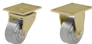
**Gehäuse:** Serie LS/BS - Besonders robuste Stahlschweißkonstruktion, Lenkgehäuse mit Axial-Rillenkugellager DIN 711 und Kegelrollenlager DIN 720 im Drehkranz, staub- und spritzwassergeschützt, mit Schmiernippel, mit eingeschweißtem, sehr stabilem Mittelbolzen verschraubt und gesichert.
