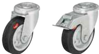
**Gehäuse:** Serie LIR - Aus Stahlblech gepresst , mit zweifacher Kugellagerung im Drehkranz , mit stabilem Mittelbolzen , Kugelschutz durch besondere Formgebung der Bodenplatte. Die spezielle dynamische Vernietung des Drehkranzes bewirkt leichtgängigen Lauf , eine hohe Lebensdauer und ein dem Hochtemperaturreinsatz angepasstes Drehkranzspiel , mit hochhitzebeständigem Fett . Radachse verschraubt.
