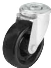
**Gehäuse:** Serie LIR - Aus Stahlblech gepresst , mit zweifacher Kugellagerung im Drehkranz , mit stabilem Mittelbolzen , Kugelschutz durch besondere Formgebung der Bodenplatte. Die spezielle dynamische Vernietung des Drehkranzes bewirkt leichtgängigen Lauf , eine hohe Lebensdauer und ein dem Hochtemperaturreinsatz angepasstes Drehkranzspiel , mit hochhitzebeständigem Fett. Gleitlager versionen mit teflonbeschichtetem Edelstahl-Achsrohr.
