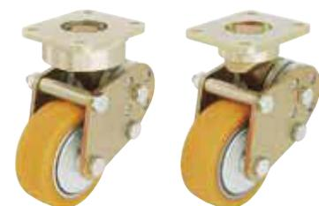
**Gehäuse:** Serie LPFE/BPFE - Solide Stahlkonstruktion , massives Schmiedeteil , Lenkgehäuse mit einem , ab Rad-Ø 125x54 mm mit zwei abgedichteten , lebensdauer- geschmierten Rillenkugell agern im Drehkranz . Durch patentierte Scheibenfederkonstruktion hervorragende Feder-Dämpfungseigenschaften . Radachse verschraubt . Galvanisch verzinkt , gelb passiviert , Cr6-frei . Gehäuseübersicht : Seite 69 Zeichnungen Anschraubpl atten : Seite 77
