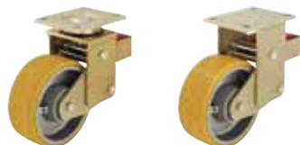
**Gehäuse:** Serie LSFN/BSFN - Besonders robuste Stahlschweißkonstruktion, Lenkgehäuse mit Axial-Rillenkugellager DIN 711 und Kegelrollenlager DIN 720 im Drehkranz, staub- und spritzwassergeschützt, mit Schmiernippel, mit eingeschweißtem, sehr stabilem Mittelbolzen verschraubt und gesichert, Gabel, Schwinge und Stahlfederelement sehr stabil ausgelegt, wartungsfreie Schwingenlagerung. Radachse verschraubt.
