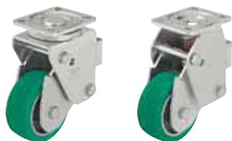
**Gehäuse:** Serie LHF/BHF - Aus starkem Stahlblech gepresst , Lenkgehäuse mit schwerer Gabel und Anschraubplatte , mit sehr stabilem Mittelbolzen verschraubt und gesichert , mit zweifacher Kugellagerung im Drehkranz , zusätzlich verstärkt durch **vier speziell geformte , gehärtete Lagerschalen** , dadurch besonders unempfindlich gegen Stöße und Schläge.
