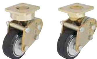
**Gehäuse:** Serie LPFE/BPFE - Solide Stahlkonstruktion , massives Schmiedeteil , Lenkgehäuse mit einem , ab Rad-Ø 125x50 mm mit zwei abgedichteten , lebensdauer-geschmierten Rillenkugellagern im Drehkranz . Durch patentierte Scheibenfederkonstruktion hervorragende Federdämpfungseigenschaften . Radachse verschraubt . Galvanisch verzinkt , gelb passiviert , Cr6-frei . Gehäuseübersicht : Seite 69 Zeichnungen Anschraubplattent : Seite 77
