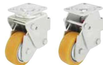
**Gehäuse:** Serie LHF/BHF - Aus starkem Stahlblech gepresst , Lenkgehäuse mit schwerer Gabel und Anschraubplatte , mit sehr stabilem Mittelbolzen verschraubt und gesichert , mit zweifacher Kugellagerung im Drehkranz , zusätzlich verstärkt durch **vier speziell geformte , gehärtete Lagerschalen** , dadurch besonders unempfindlich gegen Stöße und Schläge.
