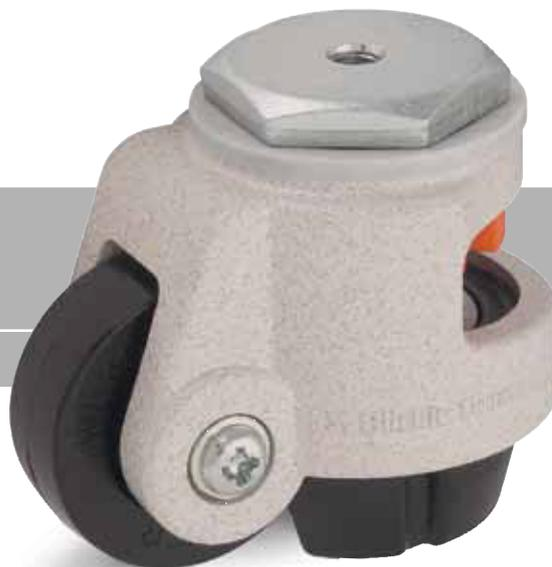
**Gehäuse:** Serie HRIG - Aus Aluminium-Druckguss, mit abgedichteter Kugellagerung im Drehkranz, mit Sechskant-Stahlplatte, mit Innengewinde im Rückenloch.
