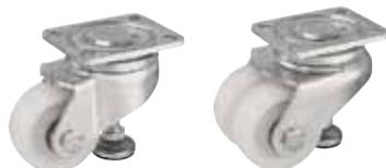
**Gehäuse:** Serie HRLH/HRLHD - Aus starkem Stahlblech gepresst , mit schwerer Gabel und Anschraubplatte , mit sehr stabilem Mittelbolzen verschraubt und gesichert , mit zweifacher Kugellagerung im Drehkranz , zusätzlich verstärkt durch **vier speziell geformte , gehärtete Lager - schalen** , dadurch besonders unempfindlich gegen Stöße und Schläge.
