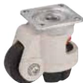
**Gehäuse:** Serie HRP/HRSP - Aus Aluminium-Druckguss , mit abgedichteter Kugellagerung im Drehkranz , mit Stahl - anschraubplatte . Pulverbeschichtet , elfenbein . Feststellfuß aus Hartgummi , Serie HRSP aus Aluminium , schwarz . Höhenverstellung mittels Gabelschlüssel oder integriertem Verstellrad; Serie HRSP nur mittels Gabelschlüssel. Radachse verschraubt. Stahlteile galvanisch verzinkt , blau passiviert , Cr6-frei. Gehäuseübersicht : Seite 73 Zeichnungen Anschraubplatten : Seite 77
