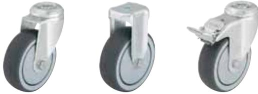
**Gehäuse:** Serie LRA/BRA , LKRA/BKRA - Aus Stahlblech gepresst , Lenkgehäuse mit zweifacher Kugellagerung im Drehkranz , mit stabilem Mittelbolzen , Kugelschutz durch besondere Formgebung der Bodenplatte und Kugelscheibe . Die spezielle dynamische Vernietung des Drehkranzes bewirkt ein minimales Drehkranzspiel bei leichtgängigem Lauf und eine hohe Lebensdauer durch die Kaltverfestigung der Kugellaufbahnen.
