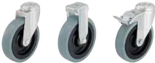
**Gehäuse:** Serie LRA/BRA, LKRA/BKRA - Aus Stahlblech gepresst, Lenkgehäuse mit zweifacher Kugellagerung im Drehkranz, mit stabilem Mittelbolzen, Kugelschutz durch besondere Formgebung der Bodenplatte und Kugelscheibe. Die spezielle dynamische Vernietung des Drehkranzes bewirkt ein minimales Drehkranzspiel bei leichtgängigem Lauf und eine hohe Lebensdauer durch die Kaltverfestigung der Kugellaufbahnen.
