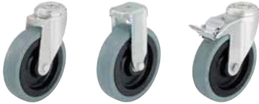
**Gehäuse:** Serie LKRA/BKRA - Aus Stahlblech gepresst , Lenkgehäuse mit zweifacher Kugellagerung im Drehkranz mit stabilem Mittelbolzen , Kugelschutz durch besondere Formgebung der Bodenplatte und Kugelscheibe . Die spezielle dynamische Vernietung des Drehkranzes bewirkt ein minimales Drehkranzspiel bei leichtgängigem Lauf und eine hohe Lebensdauer durch die Kaltverfestigung der Kugellaufbahnen.
