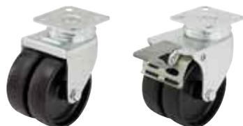
**Gehäuse:** Serie LDA - Aus Stahlblech gepresst, mit zweifacher Kugellagerung im Drehkranz, Kugelschutz durch besondere Formgebung der Bodenplatte und Kugelscheibe, Drehkranz vernietet.
