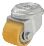
**Gehäuse:** Serie LRA/LKRA - Aus Stahlblech gepresst , mit zweifacher Kugellagerung im Drehkranz , mit stabilem Mittelbolzen , Kugelschutz durch besondere Formgebung der Bodenplatte und Kugelscheibe . Die spezielle dynamische Vernietung des Drehkranzes bewirkt ein minimales Drehkranzspiel bei leichtgängigem Lauf und eine hohe Lebensdauer durch die Kaltverfestigung der Kugellaufbahnen.
