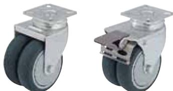
**Gehäuse:** Serie LDA - Aus Stahlblech gepresst, mit zweifacher Kugellagerung im Drehkranz, Kugelschutz durch besondere Formgebung der Bodenplatte und Kugelscheibe, Drehkranz vernietet. Radachse verschraubt. Galvanisch verzinkt, blau passiviert, Cr6-frei. Gehäuseübersicht : Seite 62 Zeichnungen Anschraubplatten : Seite 76 Rad- und Drehkranzbremse "stop-fix" : Seite 80
