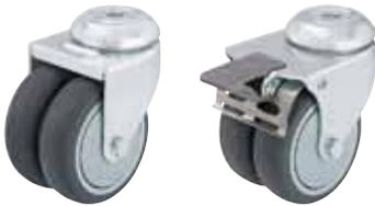
**Gehäuse:** Serie LMDA - Aus Stahlblech gepresst , mit zweifacher Kugellagerung im Drehkranz , Kugelschutz durch besondere Formgebung der Bodenplatte und Kugelscheibe , Drehkranz vernietet .
