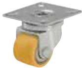
**Gehäuse:** Serie LPA/LKPA - Aus Stahlblech gepresst, mit zweifacher Kugellagerung im Drehkranz, mit stabilem Mittelbolzen, Kugelschutz durch besondere Formgebung der Bodenplatte und Kugelscheibe. Die spezielle dynamische Vernietung des Drehkranzes bewirkt ein minimales Drehkranzspiel bei leichtgängigem Lauf und eine hohe Lebensdauer durch die Kaltverfestigung der Kugellaufbahnen.
