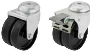
**Gehäuse:** Serie LMDA - Aus Stahlblech gepresst , mit zweifacher Kugellagerung im Drehkranz , Kugelschutz durch besondere Formgebung der Bodenplatte und Kugelscheibe , Drehkranz vernietet .
